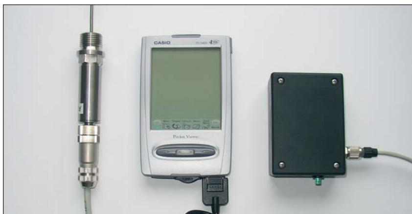
MST-Prüffühler-Set bestehend aus Prüffühler, PDA und Batteriebox
