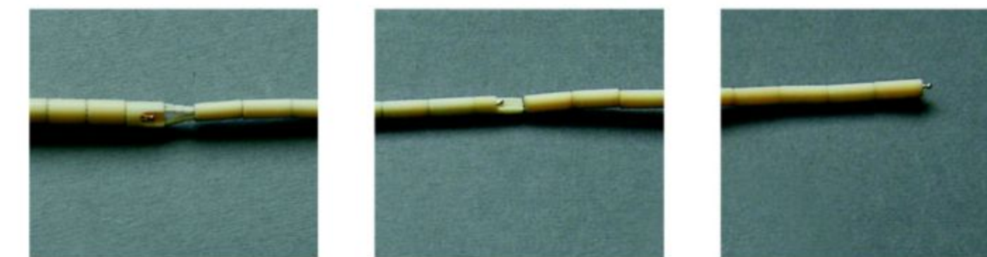
Keramikteile verjüngen sich von Messstelle zu Messstelle
